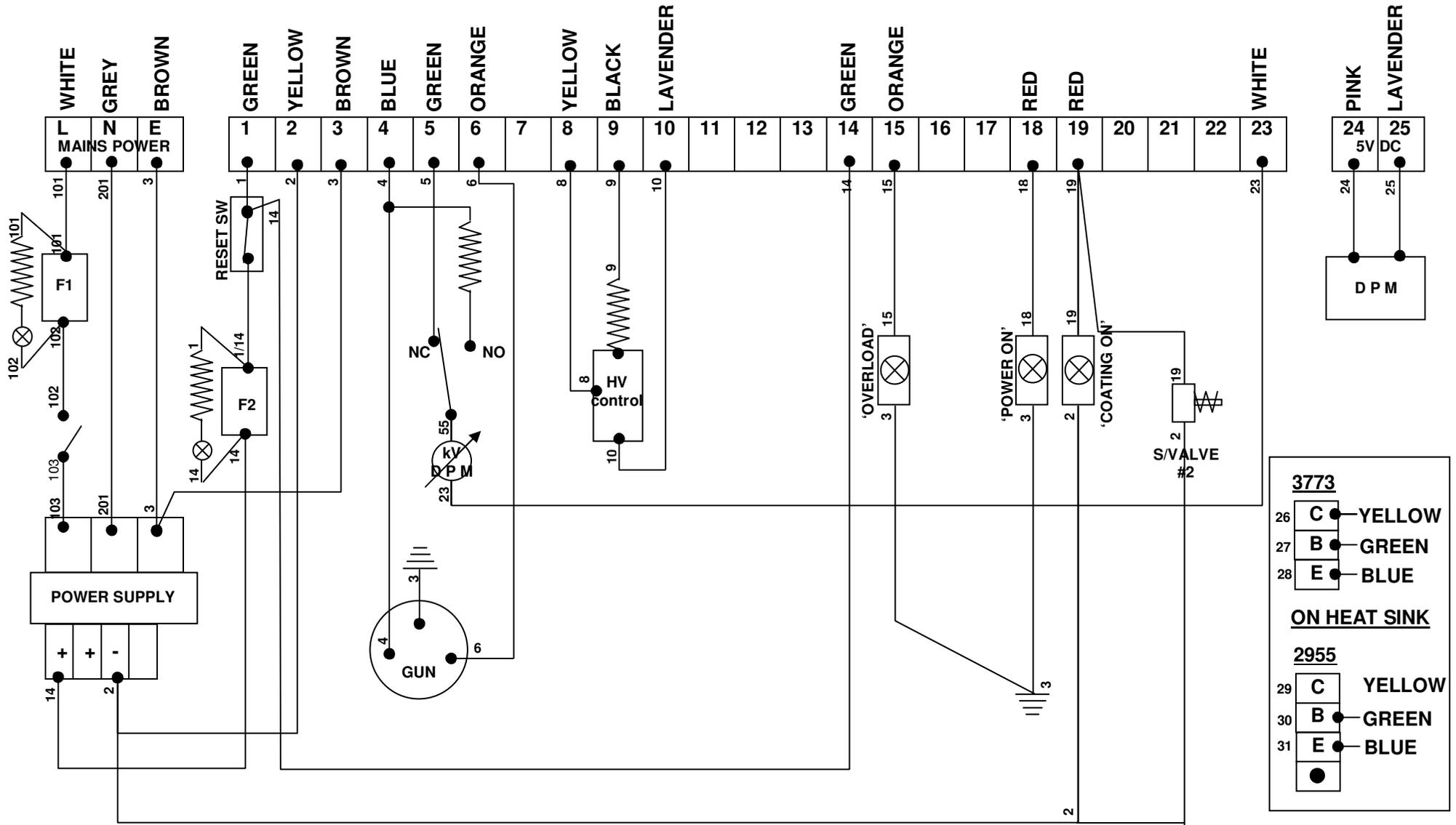
**WIRING DIAGRAM INSIDE CONTROL PANEL**
